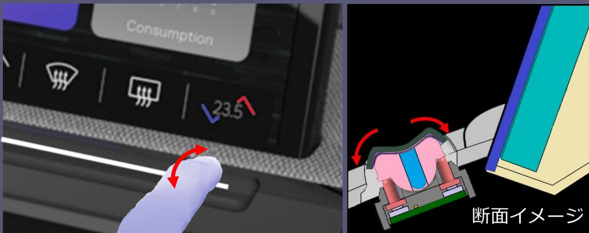
温度調整等の上下操作に適している
