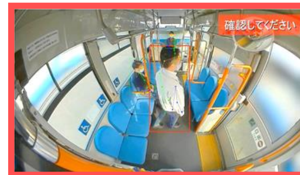
不安全姿勢 手すり、つり革を持たない立ち上がり
